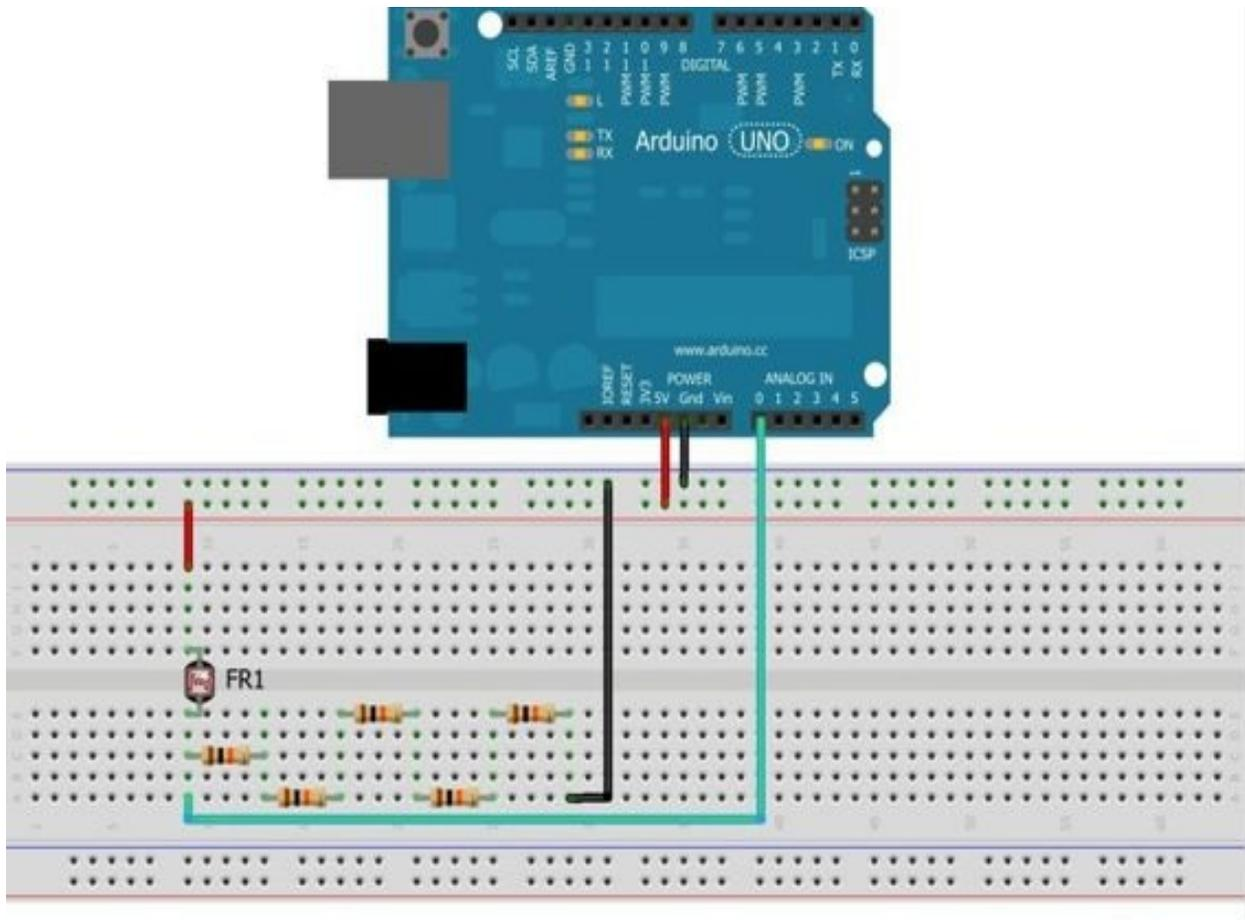
*Per il progetto sarebbe richiesta una resistenza pari a  $50\text{ k}\Omega$  che non si trovano in vendita. Dovrai collegare 5 resistenze da  $10\text{ k}\Omega$  in serie come nella figura soprastante.*
