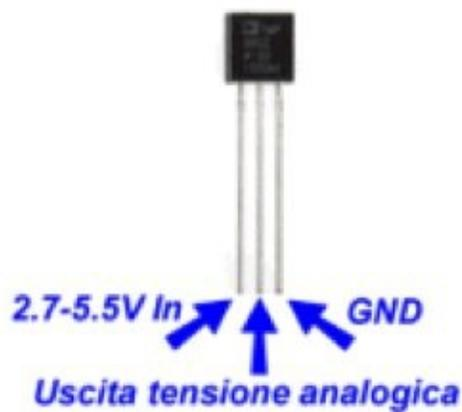
Questo tipo di sensore è uno dei più precisi e ha la possibilità di lavorare a tensioni bassissime 2,2V – 5V.
