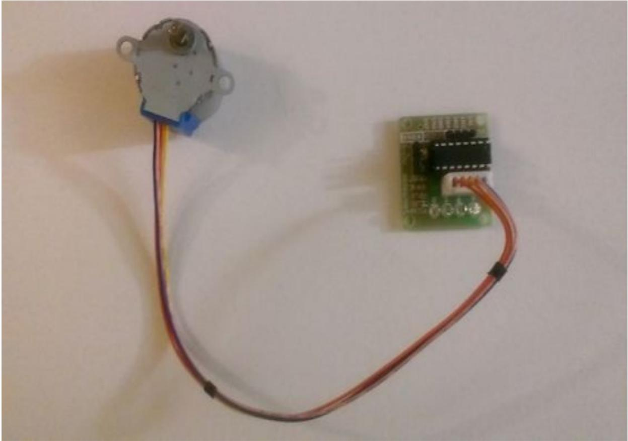
Questo tipo di motore passo-passo contiene una scheda driver, che svolge la funzione di compilazione dei segnali che serviranno al motore.
