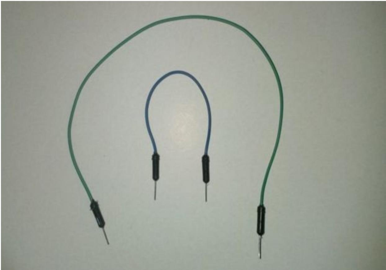
Sono cavetti di diversa lunghezza e di diverso colore che terminano con un connettore maschio – maschio adatto per connettersi ai Pin della scheda Arduino Uno fino alla Breadboard.
