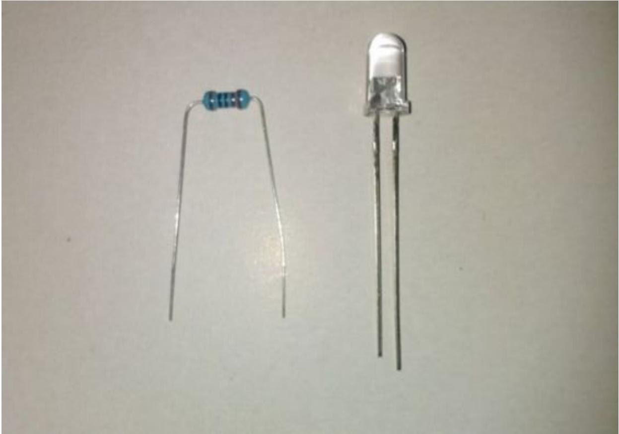
Il diodo LED (*Light Emitting Diode*) è un componente che se attraversato da una corrente molto bassa emette una luce che varia in base al metodo di costruzione.
