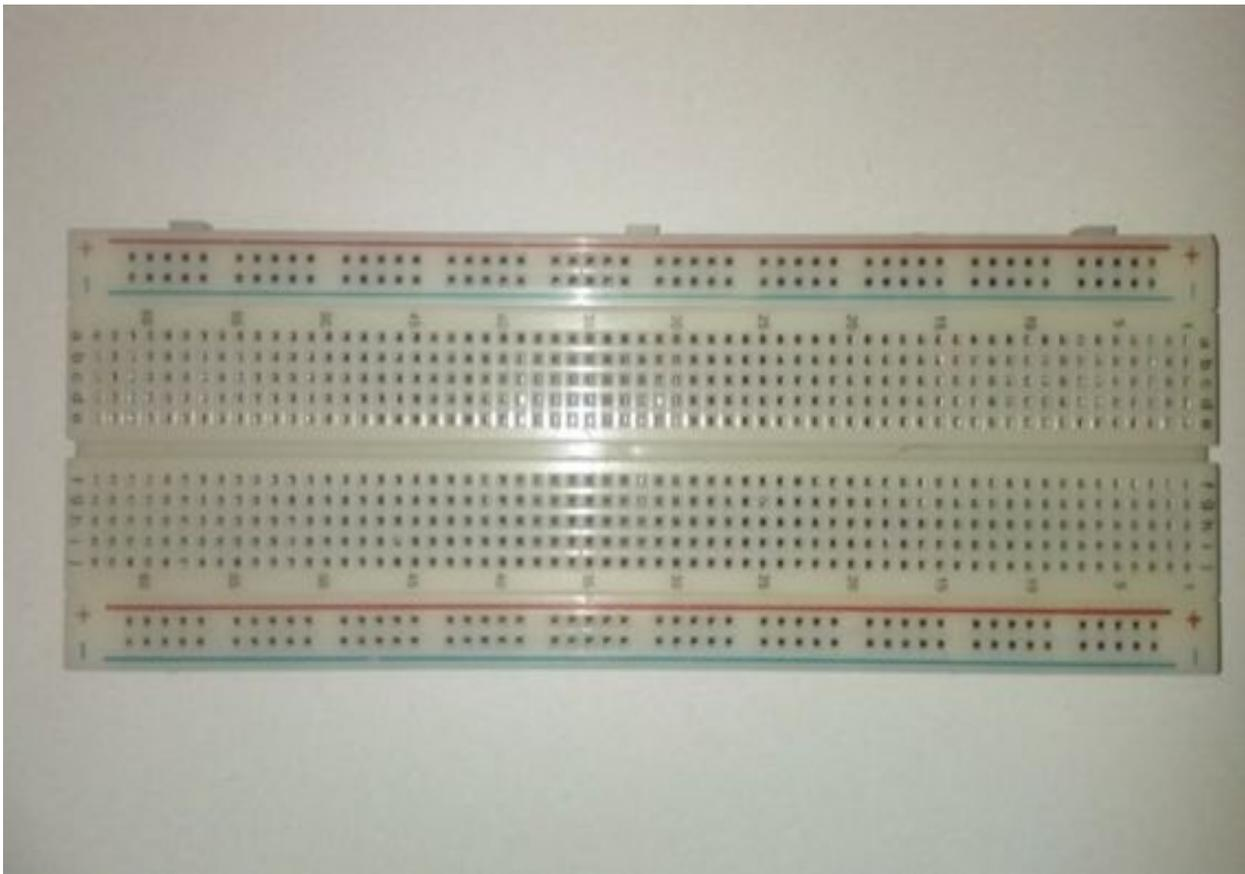
La breadboard (o basetta sperimentale) ti sarà molto utile per moltissimi dei progetti che andrai ad affrontare in questa collana di Arduino.
