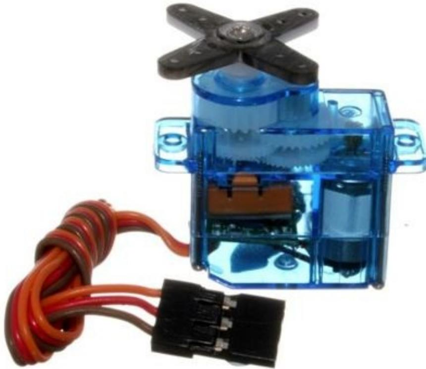
I servomotori sono composti da un motore che consente di effettuare il movimento e un sensore di posizione che indica esattamente in che punto si trova.
