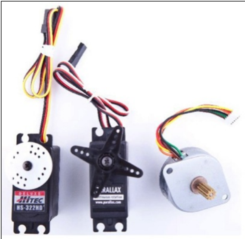
Figura 10.2 Tipi di motore (da sinistra a destra): servomotore standard, motore a rotazione continua, motore passo-passo.
