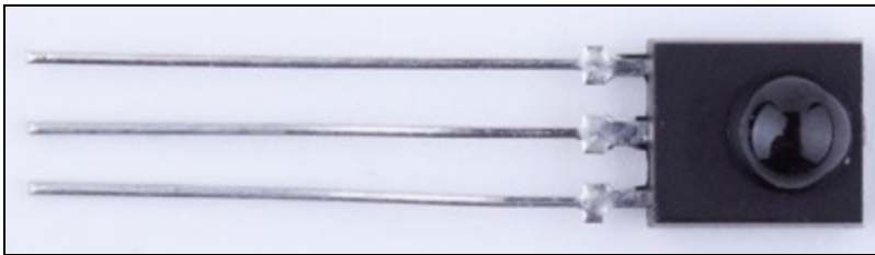
Figura 9.3 Un sensore a infrarossi PNA4602.
